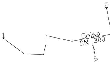
Per inserire un elemento del grafo è necessario avere due nodi ed un arco. Le primitive grafiche da inserire sono:
