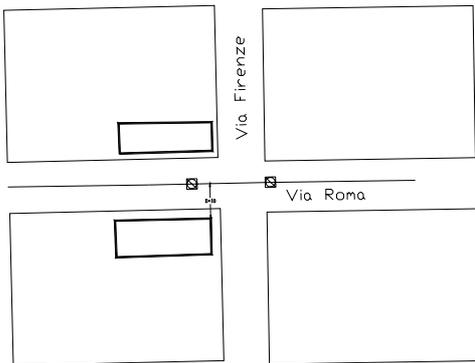
Per intersezione di due distanze. Nel Caso in cui il pozzetto A sia già identificato è possibile localizzare il pozzetto B intersecando la distanza dal pozzetto A con una seconda misura ad esempio l'allineamento di un fabbricato.
